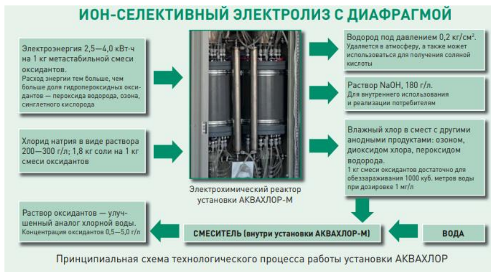
Рисунок 1.8. Схема технологического процесса работы установки АКВАХЛОР
